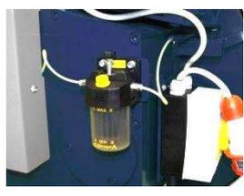
Pompa per la lubrificazione per ingrassare tutte le parti meccaniche con un unico gesto.
