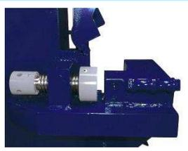
Riscontro con regolazione "a vite" per un perfetto allineamento delle barre nella zona di taglio.
